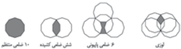
تصویر ۱۴- ایجاد اجزاء عناصر زیر ساختی شاه‌گره ایوان غربی مسجد جامع اصفهان با استفاده از ترکیب ۱۰ ضلعی‌های منتظم.
