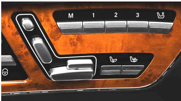
تصویر ۷- ارتباط کلیدهای کنترلی با بخش های مختلف صندلی برقی خودرو به وضوح مشخص است. ماخذ: ( http://blogs.evergreen.edu/brookewalsh )
